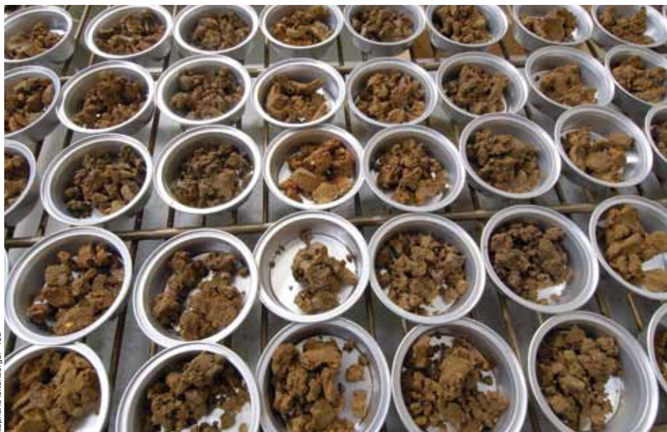
Analyse de taux d'humidité sur des échantillons de sol.
